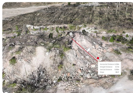
Pomiar skarpy hałdy na modelu 3D: odległość, różnica wysokości i nachylenie.
